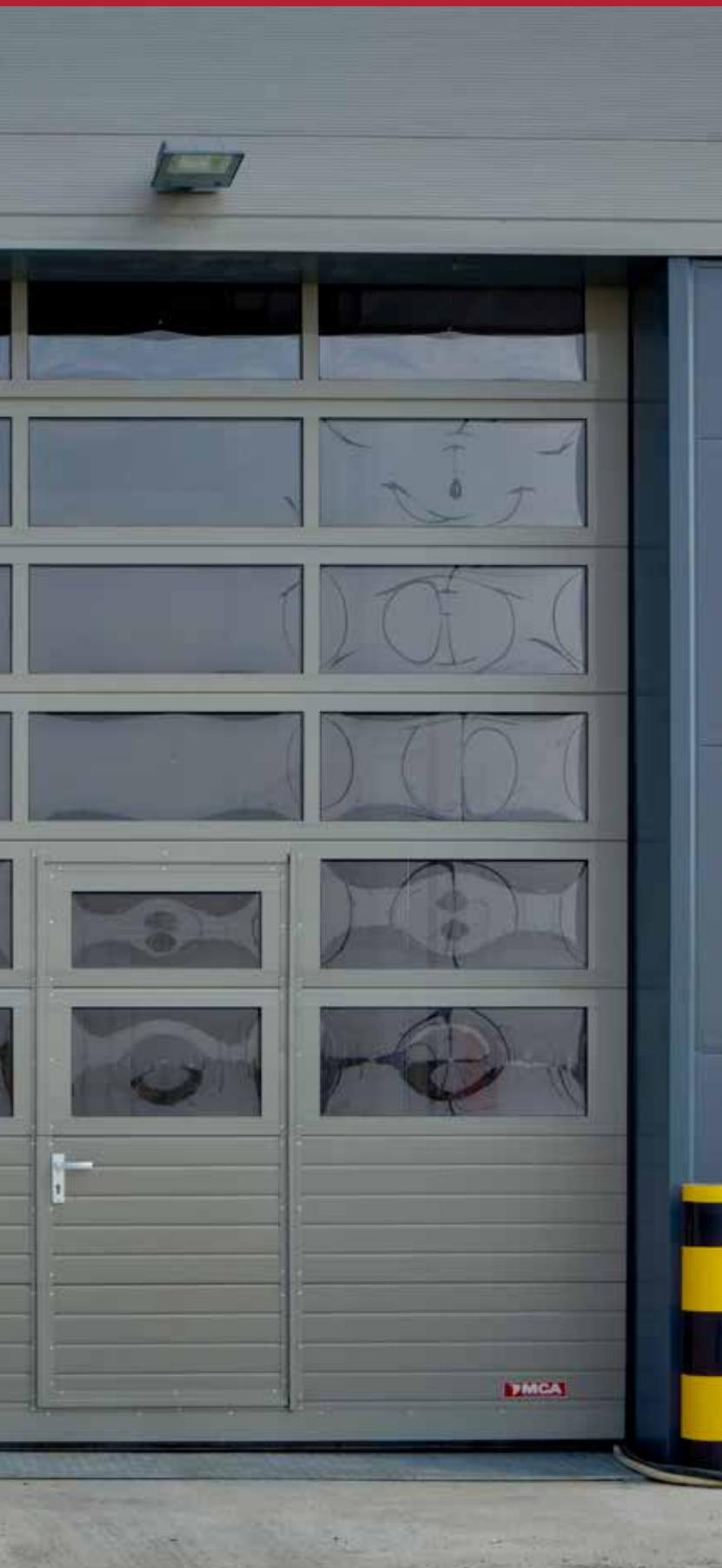
*Les portes sectionnelles industrielles ont généralement de grandes surfaces et les ouvrir complètement n'est pas toujours nécessaire. Pour cette raison, un portillon peut être installé. Il y a deux types de portillons incorporés: à seuil bas (3 cm) et à seuil normal (15cm).*
